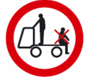
Zakaz przewozu osób na urządzeniach transportowych
