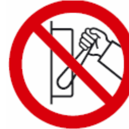
Zakaz uruchamiania urządzenia / maszyny
